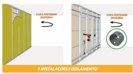
Por segurança, instalações de eletricidade para os orifícios superiores e encanamento para os inferiores. Para fazer buracos, usamos brocas de coroa. Para melhorar o comportamento termo-acústico do sistema, podemos instalar o material isolante.
