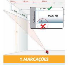
Nós marcamos as linhas das primárias e acima delas fixações. Você pode usar o perfil U no perímetro, mas nunca vai aparafusar o perfil TC.
